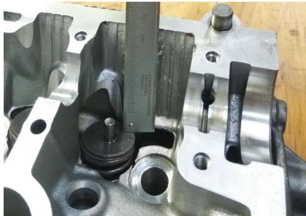
Figure 27: Longueur de ressort quand la soupape est fermée
