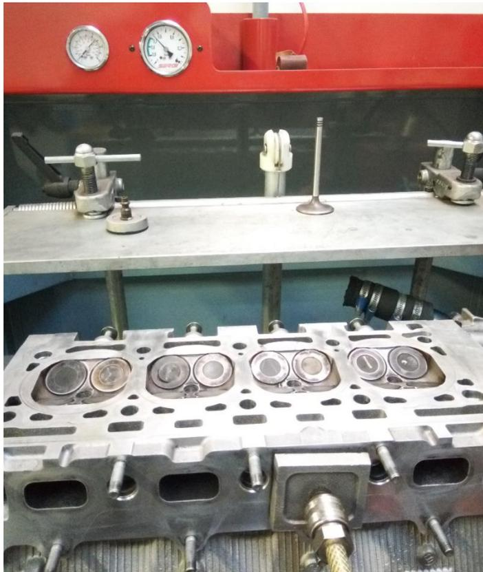
Figure 21: Étanchéité soupape
