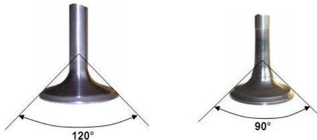
**Figure 24: L'angle portée du siège**
