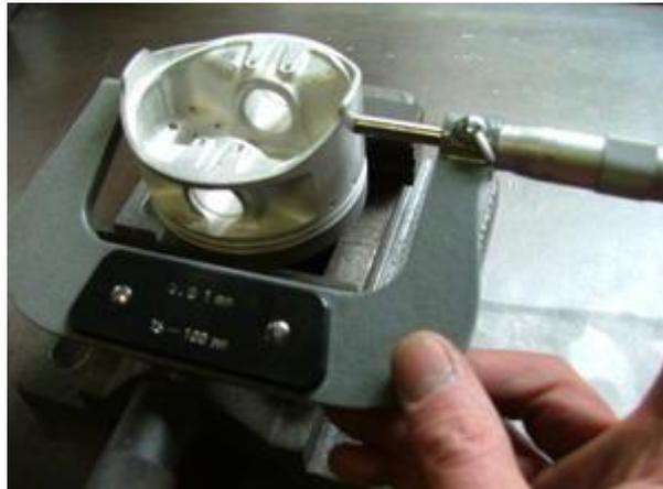
Figure 42: Mesure du diamètre de piston
