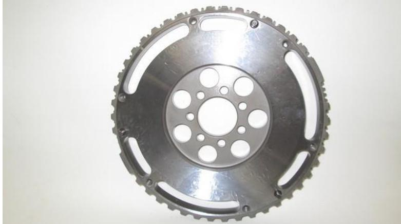
Figure 52 : volant moteur allégé
