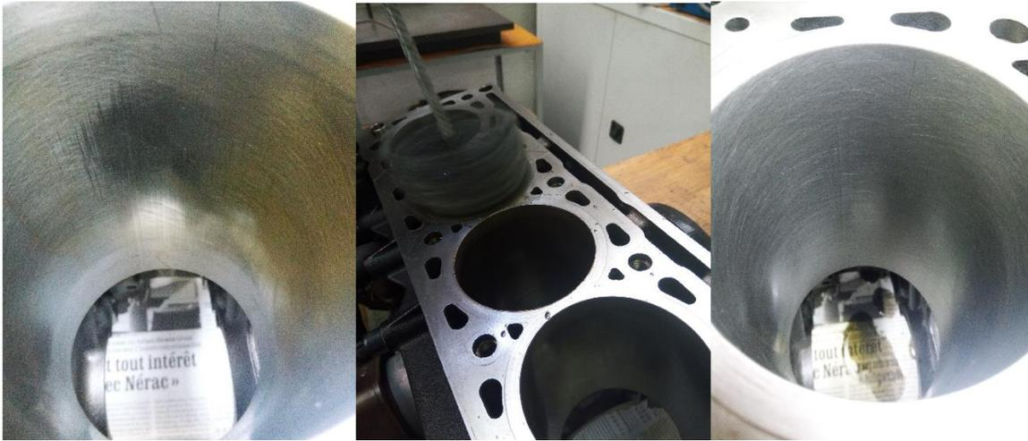
Figure 44: déglacage du cylindre
