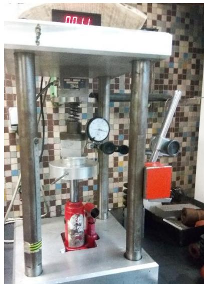
Figure 28 : Mesure de raideur du ressort
