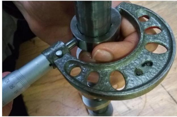
Figure 32: Mesure Levée de came
