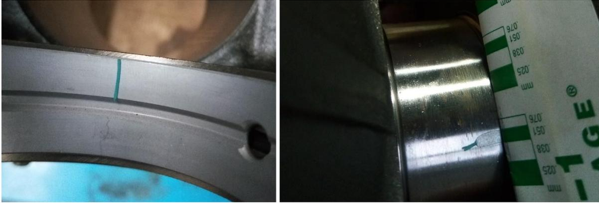
Figure 37: Mesure de jeu radial par plastigage
