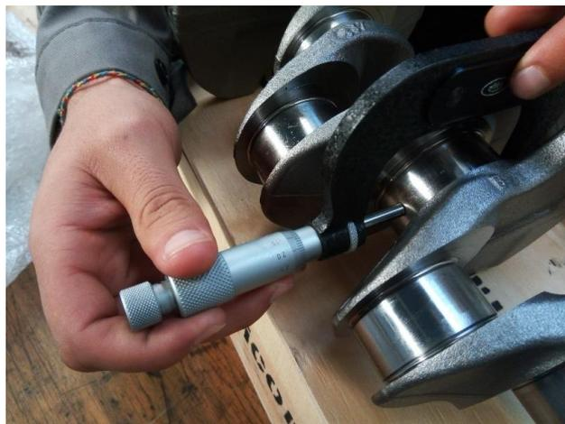
Figure 38: Mesure les diamètres du vilebrequin
