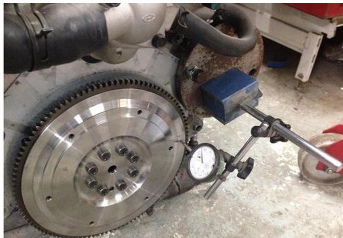
Figure 40: mesure de voile volant moteur
